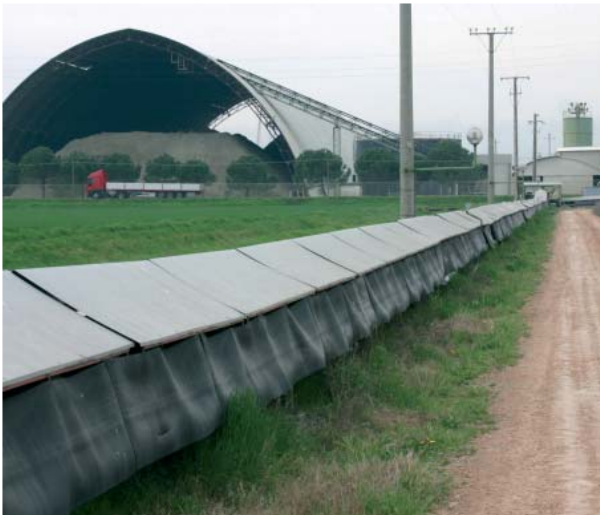
Il lungo nastro trasportatore coperto che convoglia direttamente l'argilla dalla cava allo stabilimento
