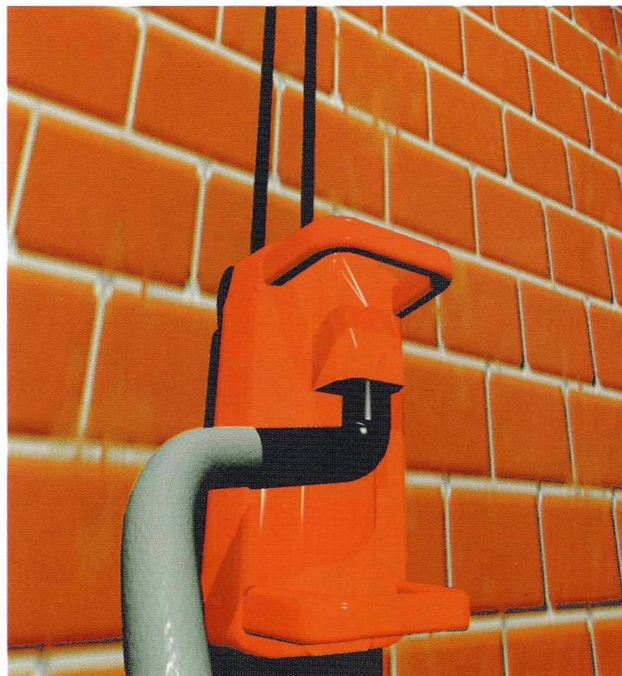
Fig. 41 - Scanalatrice con aspirazione delle polveri, per l'esecuzione delle tracce per gli impianti.
