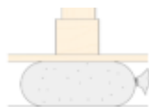
Sistema antico per il disarmo graduale delle centine con sacchi di juta pieni di sabbia
