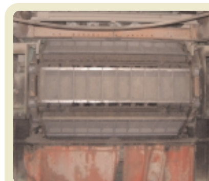
GLI STAMPI VENGONO "SABBIATI" PRIMA DI OGNI RIEMPIMENTO
