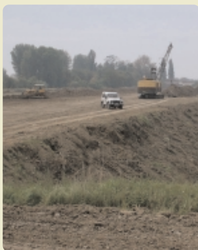
COLTIVAZIONE DI UNA CAVA DI ARGILLA CON GRU A BENNA
