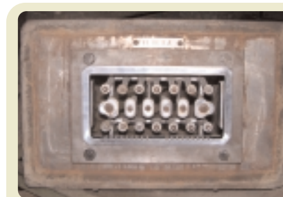
LA "BOCCA" DI UNA FILIERA RIPRODUCE, IN NEGATIVO, LA SEZIONE DEL MATTONE CHE DA ESSA VIENE ESTRUSO
