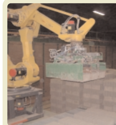
ALL'USCITA DALL'ESSICCATOIO, UN ROBOT POSIZIONA I MATTONI SUI CARRELLI CHE LI PORTERANNO NEL FORNO
