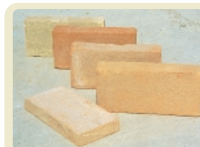
I MATTONI IN PASTA MOLLE HANNO UNA FORMA NON PERFETTAMENTE REGOLARE
